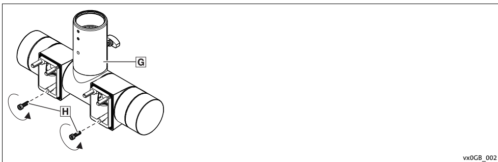
Abb. 2 Tragarm-Adapter für die Montage vorbereiten
