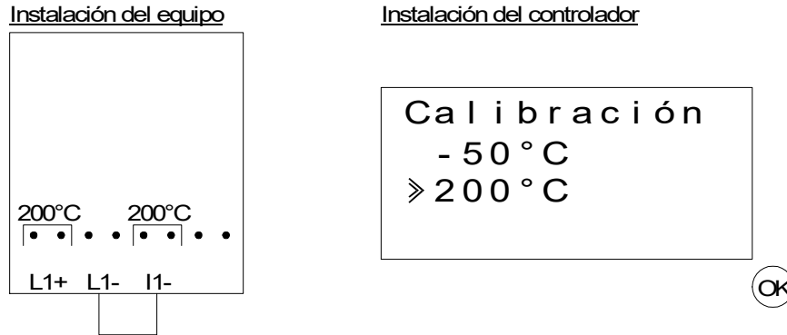
Figura 12.7: Compensación de la amplificación en el AL2-2PT-ADP
