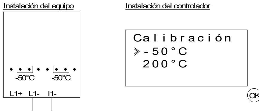
Figura 12.5: Compensación de la desviación en el AL2-2PT-ADP
