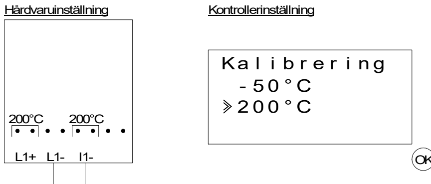
Figur 12.7: Avstämning av förstärkningen för AL2-2PT-ADP
