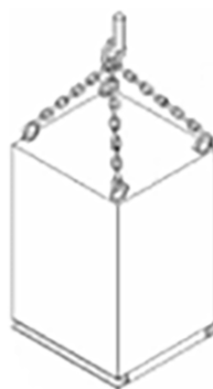
Figura 1.11: Levantamiento individual cuatro (4) puntos
