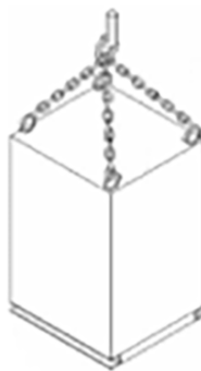
Figura 1.11: Içamento individual quatro (4) pontos
