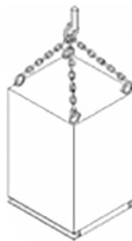
Figura 1.11: Içamento individual quatro (4) pontos
