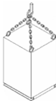
Figura 1.11: Levantamiento individual cuatro (4) puntos
