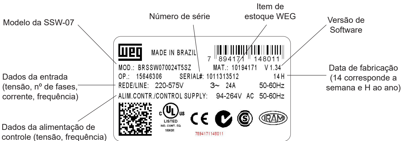
Figura 2.3 - Etiqueta de identificação na lateral da Soft-Starter SSW-07
